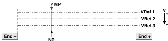
Bild 4.34 Referenzfahrttyp 0. Die aktuelle Istposition wird als Referenzpunkt gesetzt. Es wird keine Referenzfahrt ausgeführt. Beispiel: Transportband.
